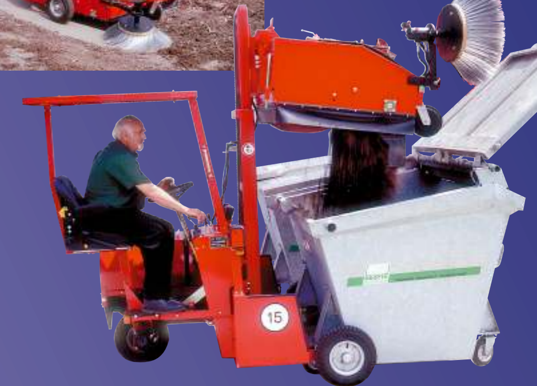
Hochentleerung in Container
